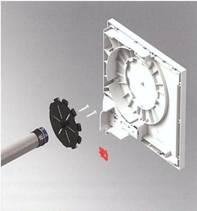
Die extrem belastbare Antriebslagerung besteht aus einer Lagerscheibe mit universellen Langlöchern. Hier kann jeder herkömmliche Motor montiert werden. Die Lagerscheibe wird über eine entsprechende Aufnahme im Kopfstück gehalten. Sie lässt sich in Schritten von  $12^\circ$  verdrehen, um die optimale Position der Einstellschrauben beim Motor festzulegen.
