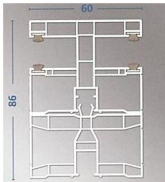
Die Führungsschiene für Raffstore und Revision außen besteht aus zwei Teilen. Dadurch kann die Führungsschiene eingeputzt werden Und es ist dennoch eine Möglichkeit zur Demontage gegeben. Für Geteilte Elemente werden die Standard – Führungsschienen durch Ein Aufdopplungsprofil auf das erforderliche Maß gebracht.
