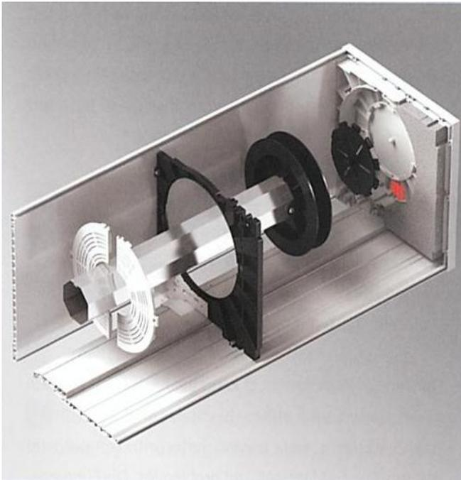
Die Doppelkopfstücke werden in den Kasten eingeschraubt. Für Kopplungen oder Teilungen stehen spezielle Einsätze zur Verfügung. Das Besondere: Die drehbaren Einsätze lassen sich wie bei einem Bajonettverschluss komplett durch das Doppelkopfstück hindurchführen. Der entstehende Durchlass im Doppelkopfstück ist dann groß genug für eine 60er Welle, so dass der Ausbau, insbesondere bei Kastenüberstand und versetztem Einlauf, enorm vereinfacht wird.
