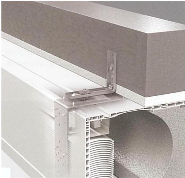
Wir bieten einen speziellen Befestigungswinkel für den Baukörper an, der dem Kasten zusätzliche Stabilität verleiht und die Last des Raffstores vollständig aufnimmt.
